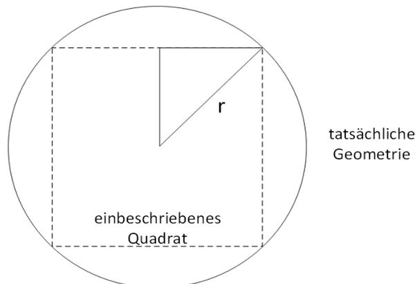
Abbildung 1: Ansetzbare Fläche bei runden Lagern zur Ermittlung des Formfaktors S<sub>mod</sub>
