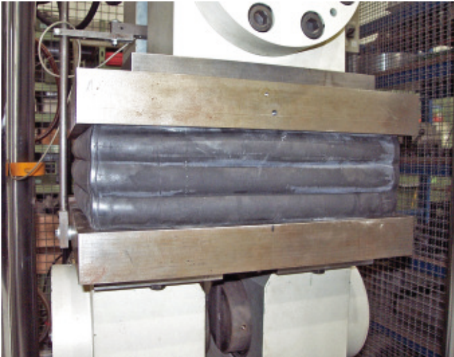
Bild 9. Gleichmäßige Druckstauchungswülste bei Maximalbelastung (Typ C) Fig. 9. Uniform flarings under maximum pressure (type C)
